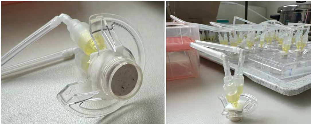
Abb. 1: Der Druckstopfen (links) dient zur Erzeugung eines definierten Druckgradienten bei der Kultivierung von FDLE-Zellmonolayern in 6-Well-Platten (rechts), die anschließend in der Ussing-Kammer analysiert werden. Dabei wird auf der apikalen Seite des Zellmonolayers ein erhöhter hydrostatischer Druck eingestellt, während die basolaterale Seite weiterhin dem Atmosphärendruck ausgesetzt ist. Auf diese Weise lassen sich die Auswirkungen eines gerichteten Druckunterschieds auf die epithelialen Transporteigenschaften gezielt untersuchen.
