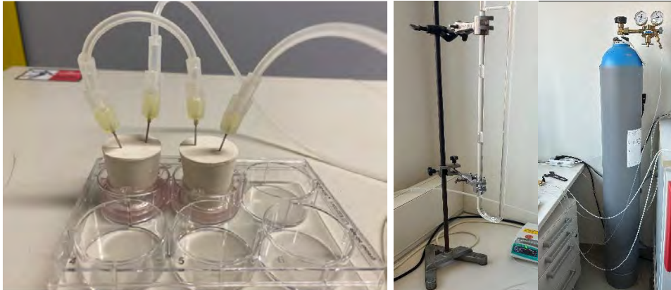
Abb. 3: ThinCert-Kultureinsätze in einer 6-Well-Platte mit selbst entwickelten Druck-Gradienten-Stopfen (links). Verbindung der Stopfen über ein Schlauchsystem mit einem wassergefüllten U-Rohr als Sperrflüssigkeit (Mitte). Ansteuerung des hydrostatischen Drucks über eine angeschlossene Gasflasche mit Druckminderer. Die Erhöhung des Drucks auf einer Seite des U-Rohrs erzeugt eine definierte Druckdifferenz, die über das Schlauchsystem auf die apikale Seite des Zellmonolayers übertragen wird.
