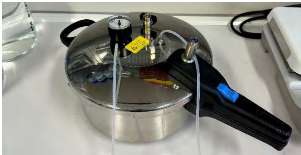
Abb. 2: Der Drucktopf dient zur Kultivierung von FDLE-Zellmonolayern unter gleichmäßigem, homogenem Luftdruck. Die 6-Well-Platten mit den Zellen werden in den Drucktopf eingesetzt, der sich während der gesamten Inkubationszeit im Zellkulturinkubator befindet. Über ein eigens entwickeltes Schlauchsystem kann der hydrostatische Druck im Inneren des Topfes präzise eingestellt und konstant gehalten werden, sodass die Zellen definierten Druckbedingungen ohne Ausbildung eines Druckgradienten ausgesetzt sind.
